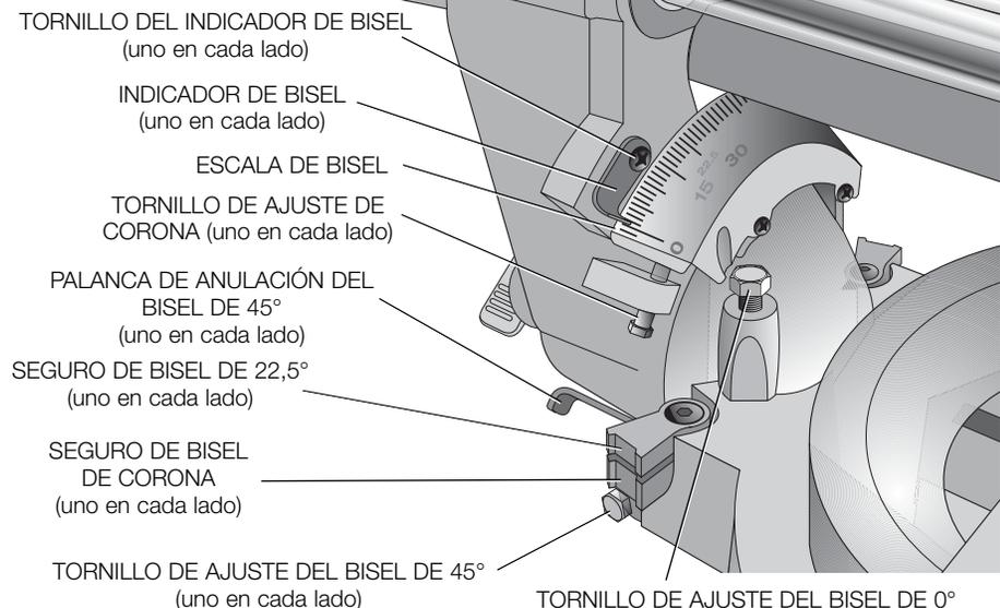
Al ser engranada, la sierra se detendrá automáticamente en 0° al ser traída desde la izquierda. Para moverse temporalmente a la derecha más allá de 0°, tire de la perilla de fijación de bisel. Una vez que se suelte la perilla, se engranará la anulación nuevamente. La perilla de fijación de bisel puede ser bloqueada girando la perilla 180°.
