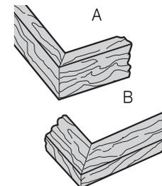
**Découpe de moulures de garnissage et d'autres cadres (fig. 14)**
